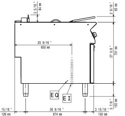
Electrical inlet (power) ΕI Equipotential screw EQ
